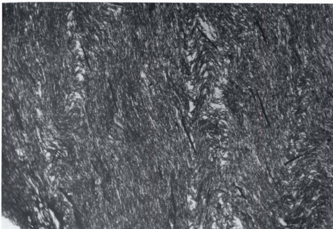
FOTOGRAFIA N° 15 (Microfotografía n° VP/114-B).- Esquistosidad S_1 intensamente crenulada por S_2 , que es la esquistosidad principal, con bandeo tectónico incipiente. X22, N//.
