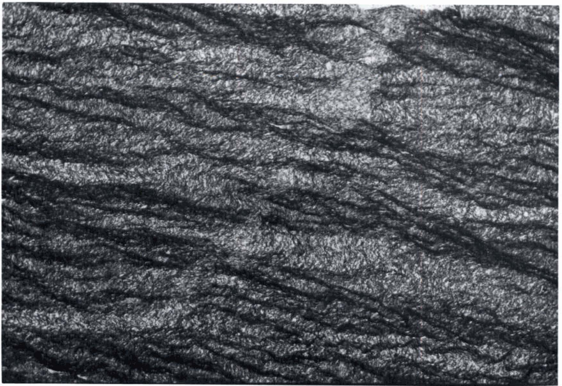
FOTOGRAFIA N° 20 (Microfotografía n° LB/154-A).- Esquistosidad S_1 microplegada por F_3 (bandeado tectónico) y ambas a su vez afectadas por la esquistosidad de crenulación S_4 , quien buza al NE más que S_3 . Pizarra de R_4 en las canteras del Bornova, Zona Bornova-Rodada. X22, N//.
