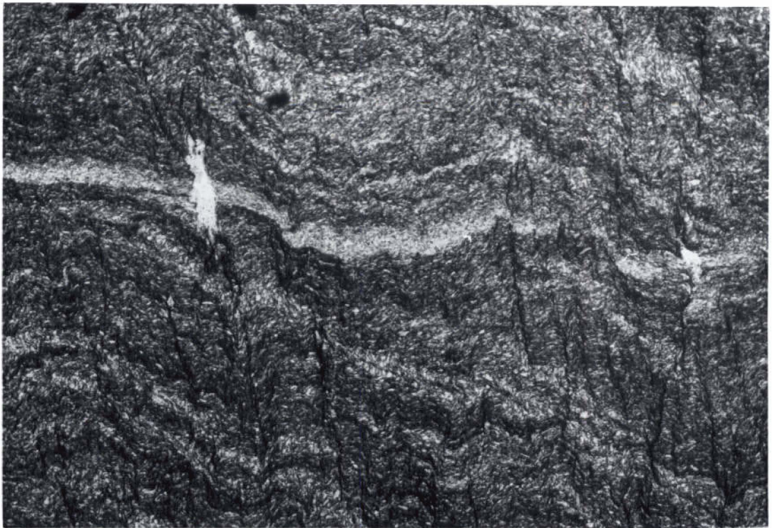
FOTOGRAFIA N o 27 (Microfotografía n o LB/153-A).- La S 0 es subparalela a S 1 , la cual está microplegada, con bandeo tectónico acompañante (bordes claros horizontales) por F 3 . Crenulación posterior de F 4 , subvertical. Pizarras de R 4 en el Molino de Lucientes, Zona Bornova-Rodada. X22, N//.
